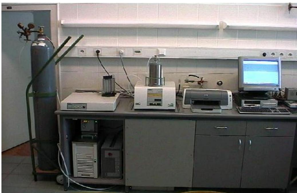
Slika 2.4. STA 449 aparatura firme Netzsch na FNT – Ljubljana
